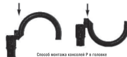
Способ монтажа консолей P в головке
