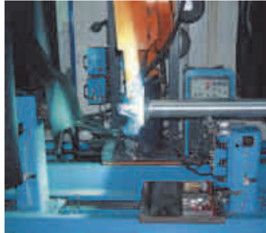
» Автоматический сварочный пост для сварки оснований
