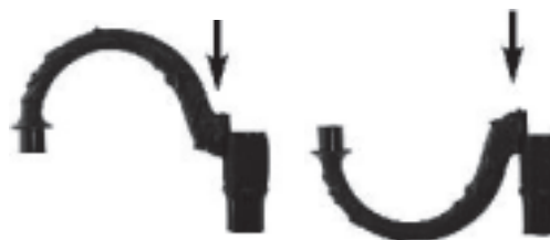
Способ монтажа консолей в головке
